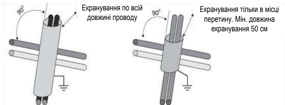
Малюнок 10. Схема екранування кабелів підключення кімнатного термостата
